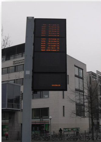
5-1 Infartstavla. Skylten visar i tur och ordning det fyrsiffriga linjenumret, turnummer, destination och tilldelad hållplats.
