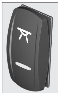
Bryter for lamper i motor- og batterirom.
